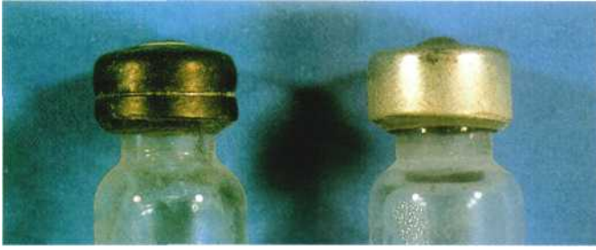
Figura 5.15. Corrosión de la tapa metálica que rodea al diafragma.
