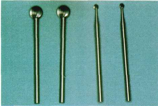
Figura 2.35. Fresas redondas de acero inoxidable del n° 20 y fresas redondas de carburo de tungsteno del n° 8.
