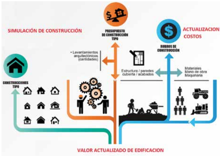
Ilustración 13. Síntesis del método de costo de reposición, que consiste en establecer el avalúo neto de un bien a precios de construcción actualizados y restarle la depreciación acumulada.
