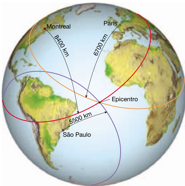
▲ Figura 11.11 El epicentro de un terremoto se localiza utilizando las distancias obtenidas desde tres o más estaciones sísmicas.
