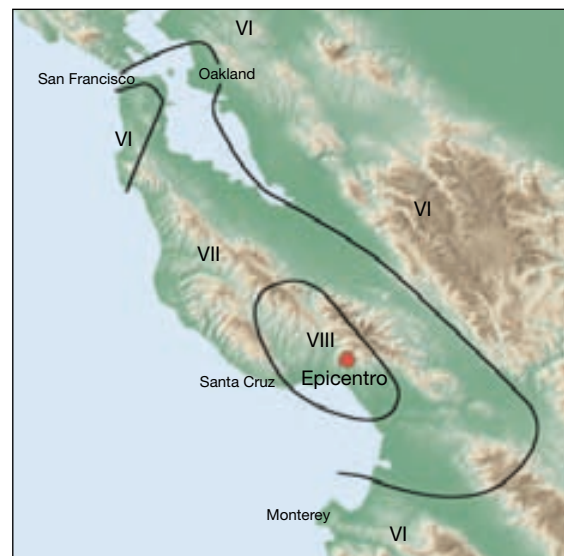
▲ Figura 11.13 Zonas de destrucción asociadas con el terremoto de Loma Prieta, California, ocurrido en 1989 utilizando la escala de intensidad de Mercalli modificada. Las cifras romanas muestran las categorías de intensidad. La zona de máxima intensidad corresponde aproximadamente al epicentro. Se experimentaron intensidades incluso más elevadas en algunos puntos de San Francisco y Oakland, donde las condiciones locales amplificaron las ondas sísmicas. (Datos de Plafker y Galloway.)
