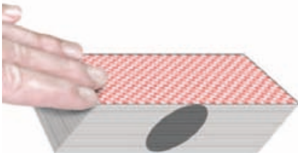
B. El cizallamiento tiene lugar cuando la mano empuja la parte superior de la baraja.
