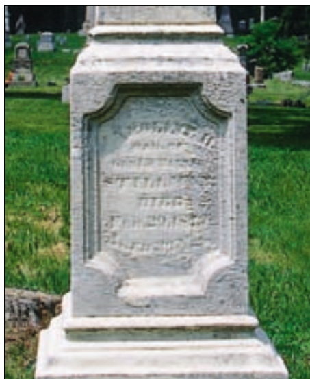
◀ Figura 6.8 El examen de las lápidas revela la velocidad de meteorización química en diversos tipos de roca. La lápida de granito (izquierda) se colocó cuatro años después que la de mármol (derecha). La fecha de inscripción de 1872 del monumento de mármol es casi ilegible. (Fotos de E. J. Tarbuck.)
