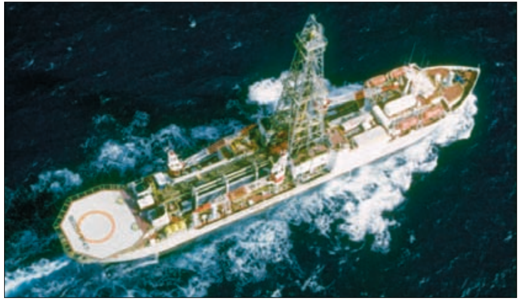
► Figura 2.25 El JOIDES Resolution , el buque para realizar sondeos del Ocean Drilling Program . Este moderno buque perforador ha sustituido al Glomar Challenger en el importante trabajo de tomar muestras de los fondos de los océanos mundiales. (Foto cortesía del Ocean Drilling Program .)
